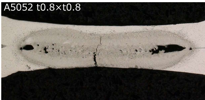
ナゲット内にクラックやブローホール Cracks and blowholes in nuggets
